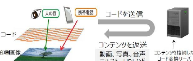
印刷する画像に人の目には分かりにくい色処理をしてコードを埋め込み、スマホを使って読み取ったコードに対応したコンテンツを表示。デザイン性を損なわずにコードを埋め込むことが出来る点が特長。読み取りアプリ(iOS/ANDROID)は無償提供されている。この技術を活用して、これまでにないサービスや、商品の検討(試作品の製作)、市場調査等を行う。
